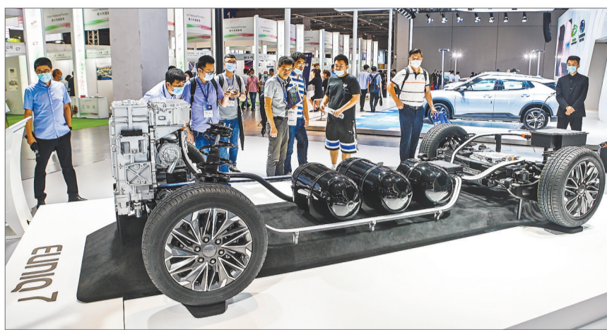
除了各种软件、硬件的整车集成,氢燃料电池汽车的核心技术还包括储氢瓶、减压阀、氢气浓度监测传感器等新物件。图为2020年中国工业博览会期间,上汽集团展出的氢燃料电池车底盘。视觉中国供图
