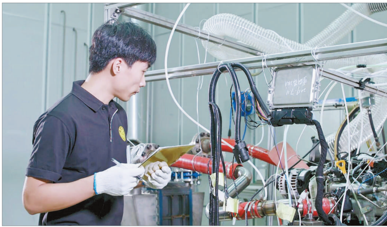
在清华大学苏州汽车研究院，一名青年汽车工程师正在进行排放后处理试验。
