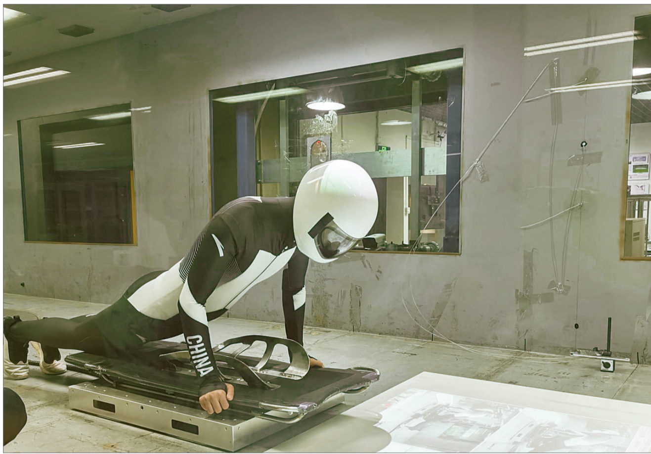
学生模拟运动员在北京交通大学风洞实验室进行风阻测试。
