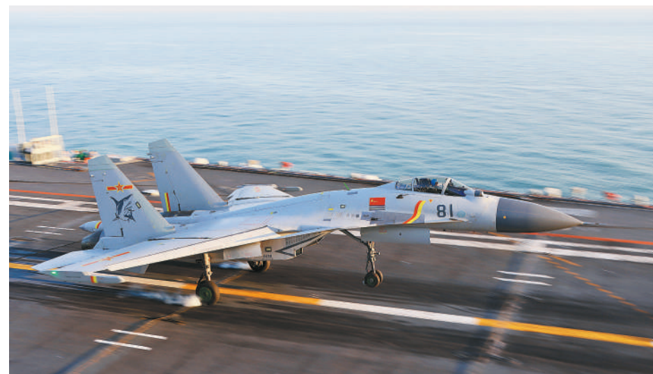
海军航空大学某基地组织昼间航母资质认证,飞行员驾驶歼-15战斗机阻拦着舰。
