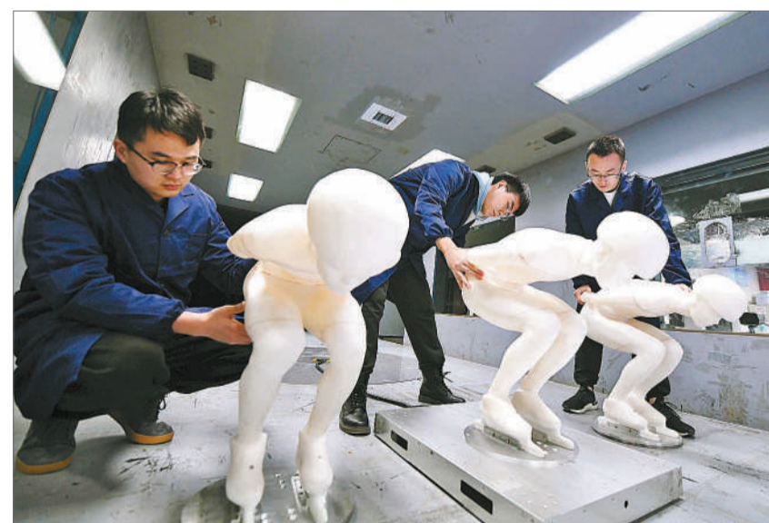
2021年11月30日，北京，为了完成部分测试项目，实验室专门通过3D打印的方法制作了三个运动员模型。北交大的同学们正把测试用模型安置在风洞中准备进行实验。视觉中国供图
