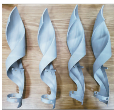
3D打印火炬内飘带。哈尔滨工业大学供图
