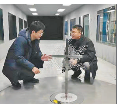
内场大雪花1/20缩尺模型风洞试验。北京交通大学供图
