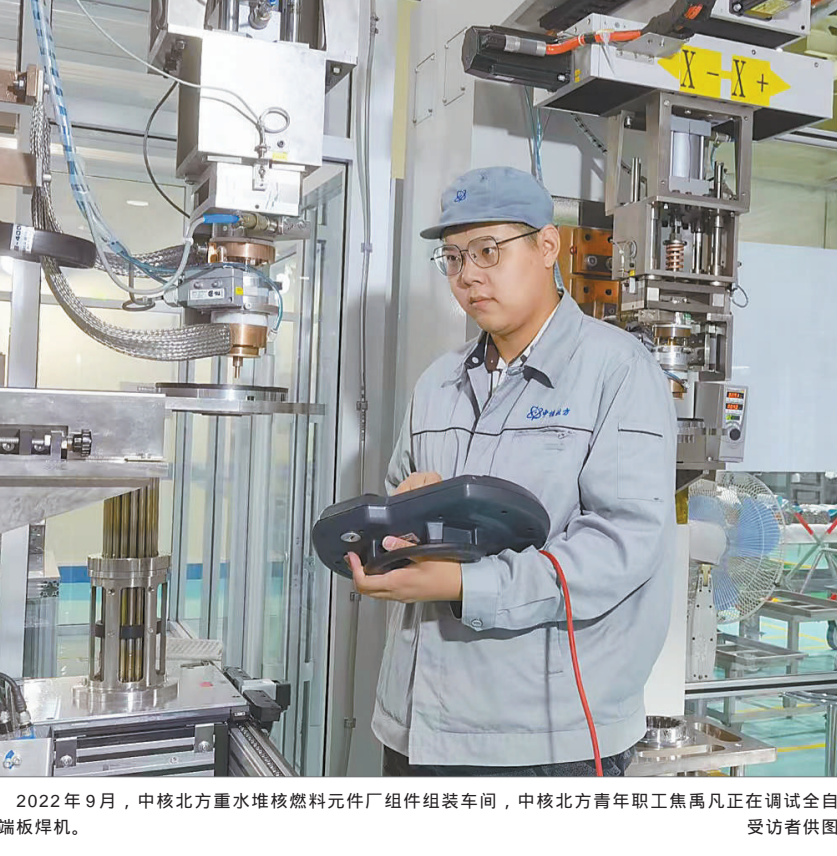
2022年9月，中核北方重水堆核燃料元件厂组件组装车间，中核北方青年职工焦禹凡正在调试全自动端板焊机。
