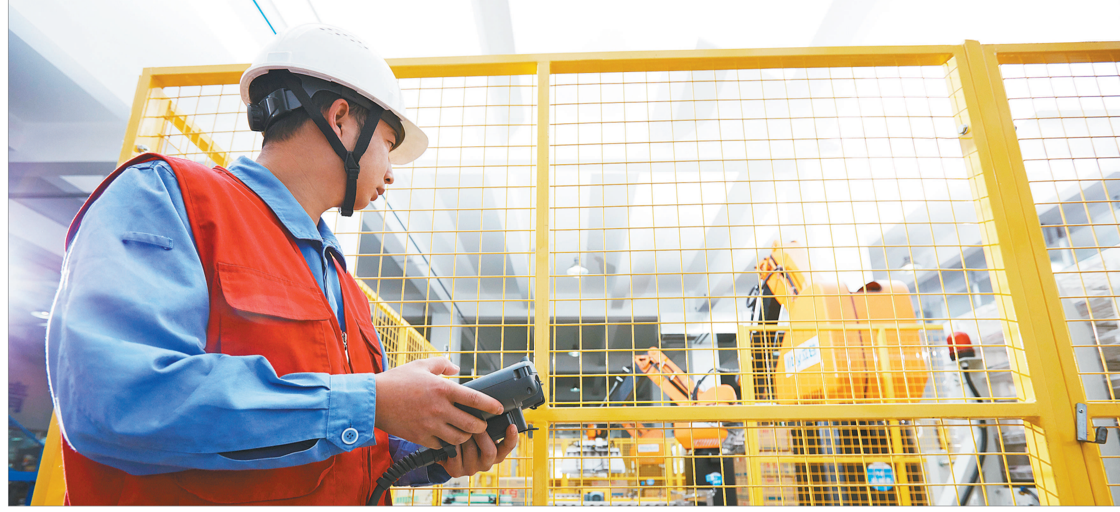
昆明白立日化有限公司液洗车间内，车间工程师正在调试产品全自动机械手码垛机。
