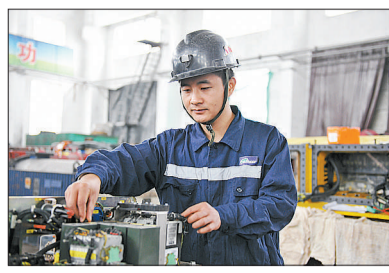
代群超正在检修采煤机主控单元。淮河能源集团供图
