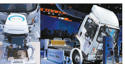
商用氢燃料电池系统TL Power80及搭载该系统的氢燃料电池轻卡
