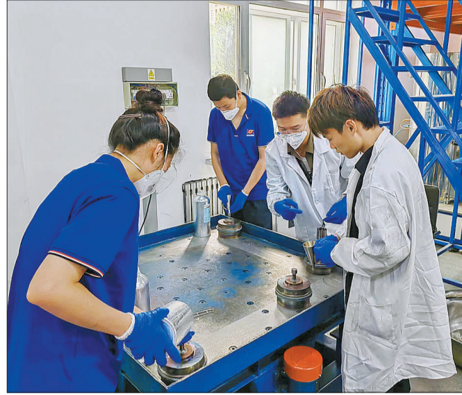
上图:中国科学院金属研究所航空发动机钛合金研发团队在进行发动机配件粉末填充铸造。徐磊供图
