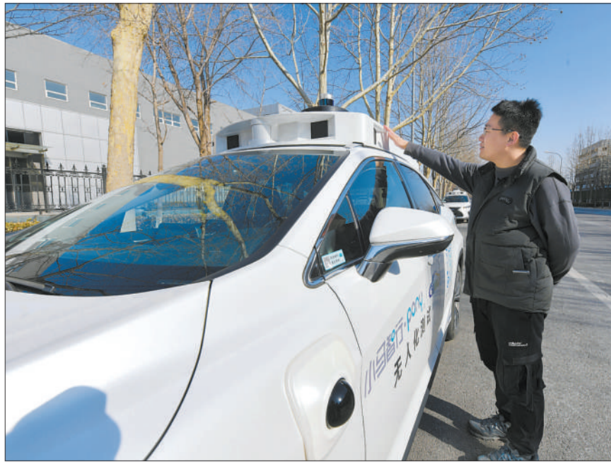
随着汽车市场“价格战”的压力逐渐传导，追求高级别自动驾驶功能面临成本压力。以图中正在测试的“整车无人”自动驾驶车辆为例，该车装有激光雷达、毫米波雷达和摄像头，硬件成本高于普通车辆。视觉中国供图
