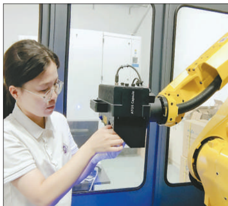
90后青年技工陈贵玲在实验室用3D扫描仪检测工件。
