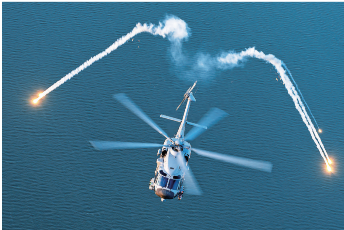
昼间海上搜救训练,面对模拟红外告警信号,直升机释放红外干扰弹,避免被“敌”导弹锁定。
