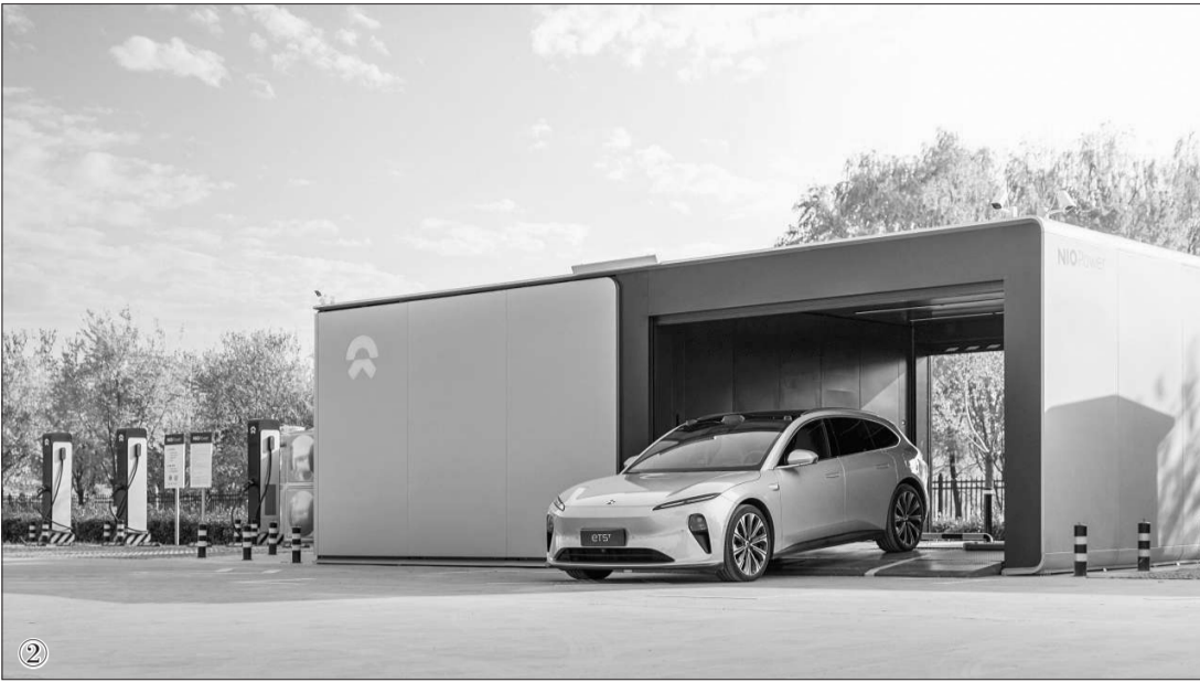
③蔚来ET7在换电站进行换电
