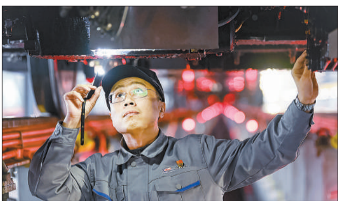
1月5日,哈尔滨动车段检修库内,动车组机械师正在动车组车下进行检修作业。
