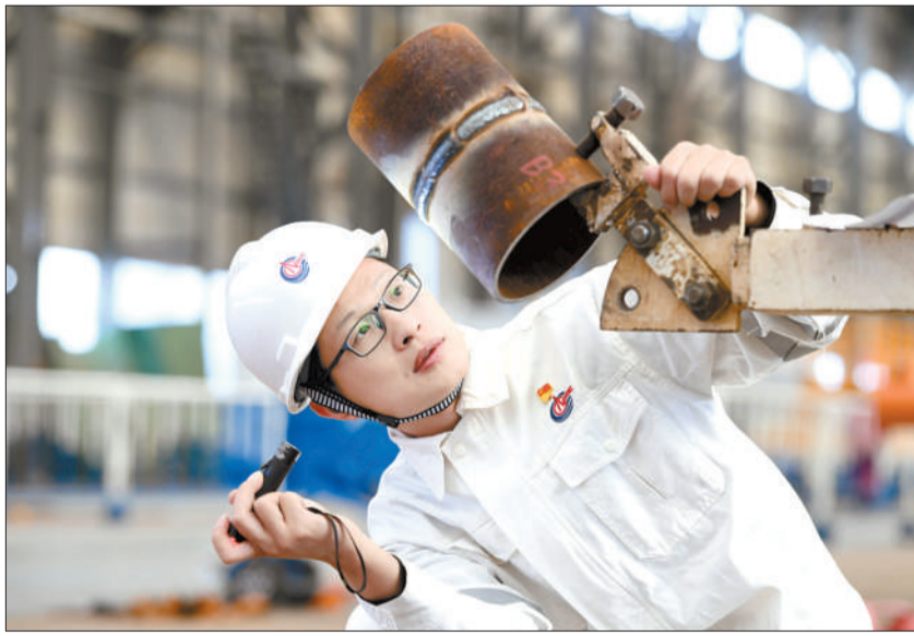
陈坤在检查焊缝。
