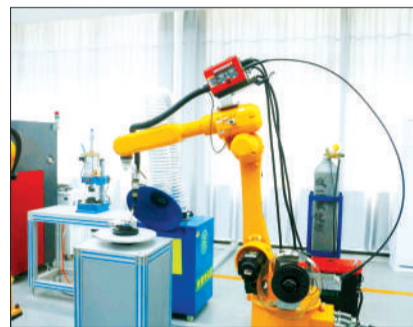
安徽机电职业技术学院智能产线上的焊接机器人。
