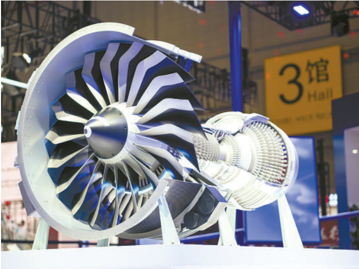
▲越过传统汽车展品的边界,第八届进博会的智慧出行画卷向着更广阔的天地延伸。图为GE航空航天在第八届进博会上展出的LEAP-1C发动机1:2剖面模型。
