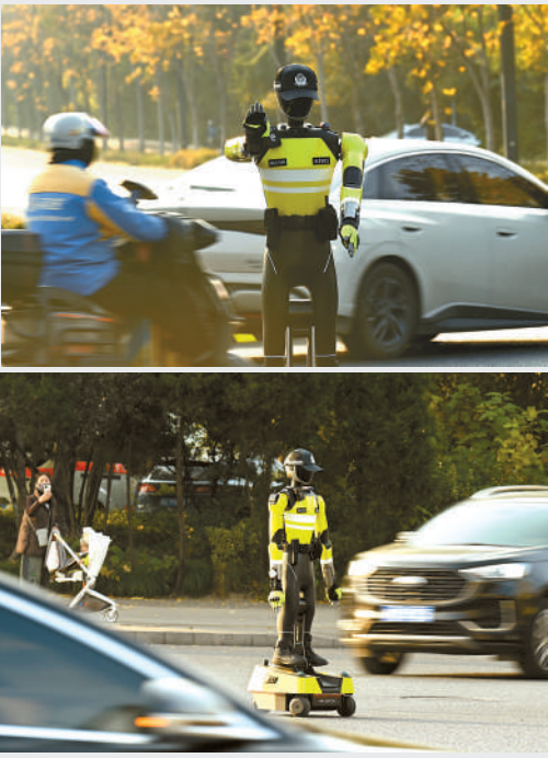
12月3日,杭州街头的AI交通管理机器人。近日,浙江杭州交警推出AI交通管理机器人“杭行1号”,该机器人可根据交通信号灯做出标准指挥动作,并依托视觉识别分析技术及时发现非机动车违法行为,进行劝导,以科技赋能交通管理。 视觉中国供图
