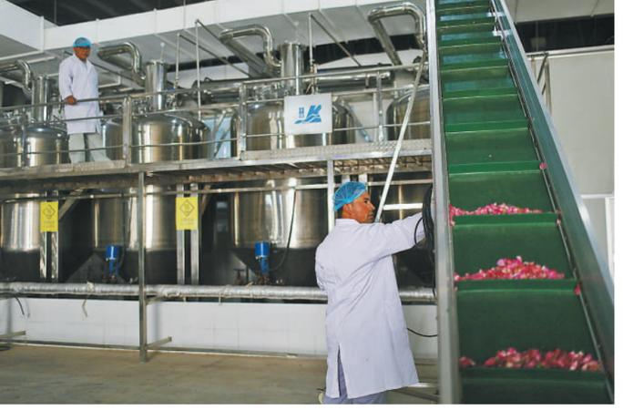
5月18日，新疆和田地区于田县，瑰见生物科技股份有限公司的蒸馏工厂，工作人员在调试玫瑰花传送带。经过打冷降温处理后，这些刚采摘下来的玫瑰花瓣会被传送带送入一台蒸馏釜里，提取纯露和精油。
