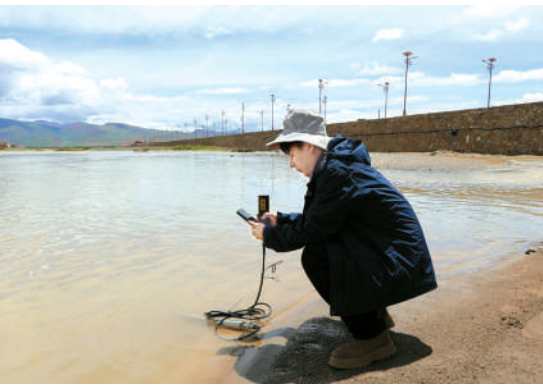
武汉大学-长江科学院江源科考联合实践队成员正在使用多参数水质检测仪测水质。受访者供图
