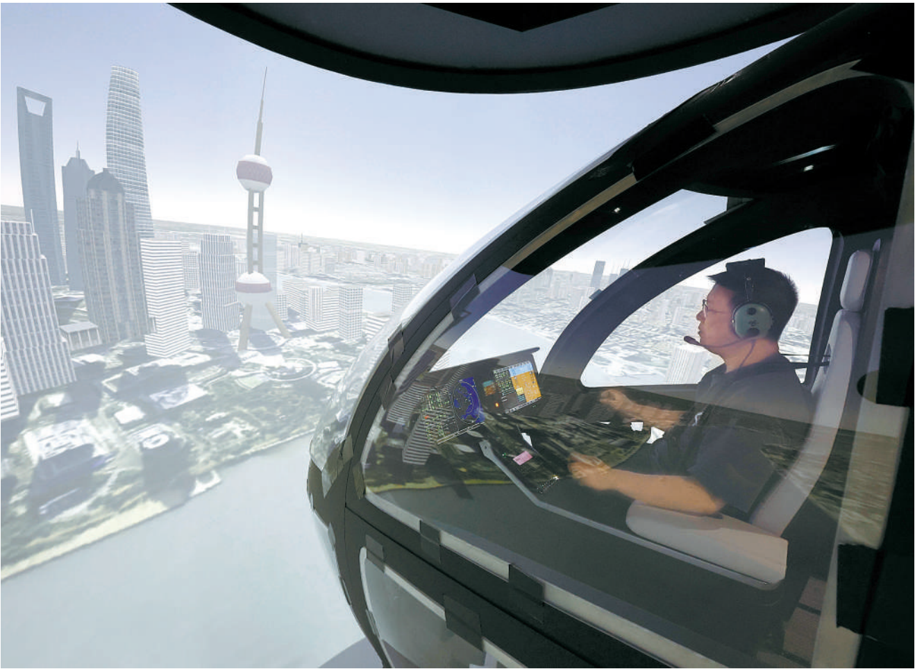
9月4日，上海，工程师在eVTOL工程模拟机上对飞行仪表进行设置。
